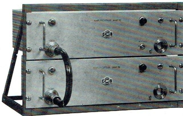
Les amplificateurs AMP 95 et 96 sont destinés à l'amplification des impulsions très brèves, qu'ils peuvent amener à un niveau permettant l'attaque de compteurs, de circuits de coïncidence et de tri, de tubes cathodiques, etc...
