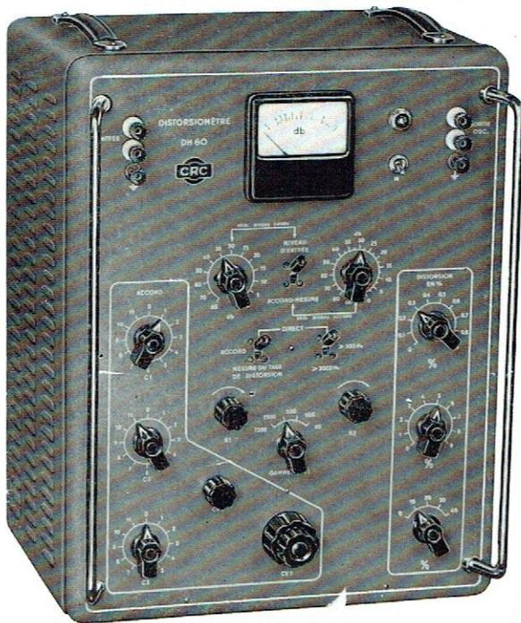
Le DH 60 est principalement destiné à la mesure de la distorsion harmonique dans la gamme des fréquences acoustiques. Son impédance d'entrée élevée, pratiquement indépendante de la fréquence, et sa grande sensibilité, permettent de mesurer quantitativement la distorsion harmonique sans amortir les circuits étudiés, et d'observer qualitativement la nature des distorsions en branchant un oscillographe aux bornes de sortie de son amplificateur.
