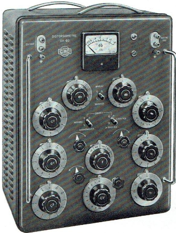
Le DH 60 est principalement destiné à la mesure de la distorsion harmonique dans la gamme des fréquences acoustiques. Son impédance d'entrée élevée, pratiquement indépendante de la fréquence, et sa grande sensibilité, permettent de mesurer quantitativement la distorsion harmonique sans amortir les circuits étudiés, et d'observer qualitativement la nature des distorsions en branchant un oscillographe aux bornes de sortie de son amplificateur.
