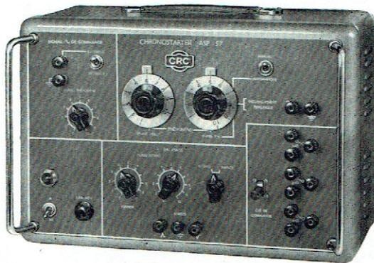
L'étude du comportement d'appareils tels que relais, disjoncteurs, moteurs, transformateurs, et d'une façon générale de tout circuit comportant un contact associé avec une bobine ou un condensateur, à l'instant de la mise sous tension (ou de la coupure), ne saurait être complète sans la connaissance exacte des phénomènes transitoires dont l'apparition est liée à la phase sous laquelle est placé cet instant.
