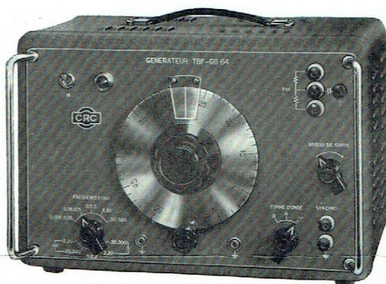
Le générateur GB 64 est un appareil destiné à fournir des signaux de fréquences très basses allant de 500 Hz à 0,005 Hz (de 1 période en 2 millisecondes à une période en 200 secondes).
