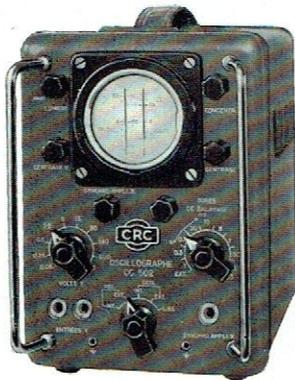
L'oscilloscope cathodique OC 502 S présente, sous un faible volume, des caractéristiques très étendues qui permettent de l'employer dans les domaines les plus variés, tels que l'électronique, la mécanique, l'électrotechnique, l'acoustique, etc.. domaines où l'oscilloscope est devenu un instrument de travail courant et indispensable.
