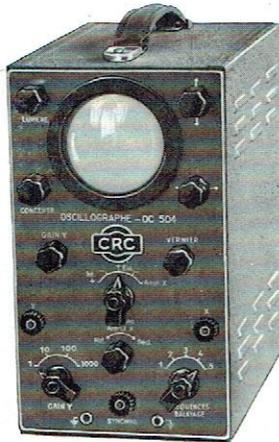
L'oscilloscope OC 504 réalise sous un faible volume un ensemble de performances remarquables qui permettent son emploi dans des domaines très variés : radiotechnique, télévision, ultrasons, télémesures, électrotechnique, etc...
