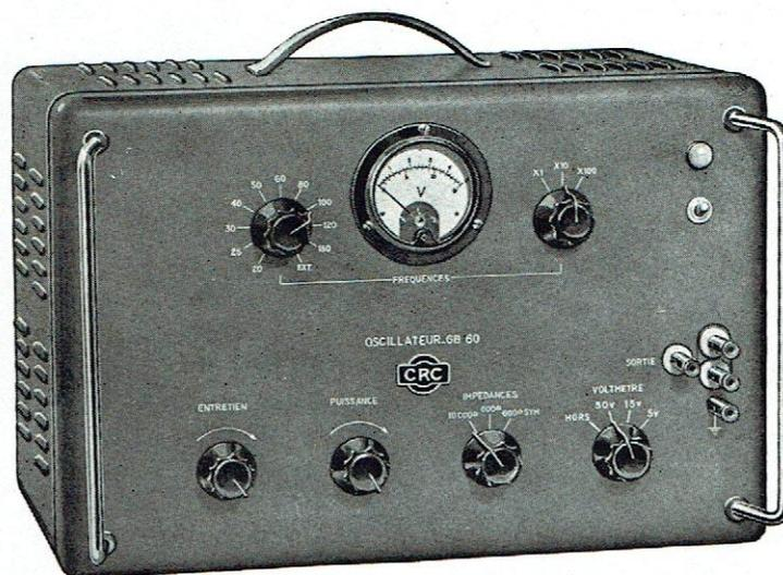
Le GB 60 est un générateur à points fixes caractérisé par une excellente stabilité en fréquence et la pureté de son signal de sortie.
