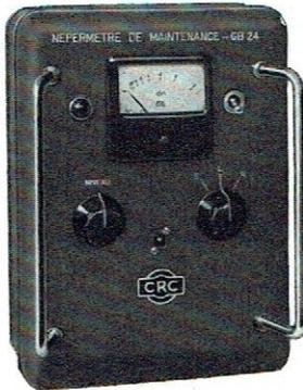
Le GB 24 est destiné à la maintenance des circuits téléphoniques et permet de contrôler à tout instant l'équivalent de transmission.
