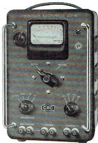
Le chronoscope électronique ASP 40 permet de mesurer la durée de phénomènes de natures très diverses : électriques, mécaniques, optiques, acoustiques etc.. Les temps mesurables sont compris entre une milliseconde et dix secondes ; on peut apprécier cent microsecondes. Il est équipé d'un dispositif de commutation qui rend immédiates les mesures des constantes de temps des différents types de relais, contacteurs, etc..
