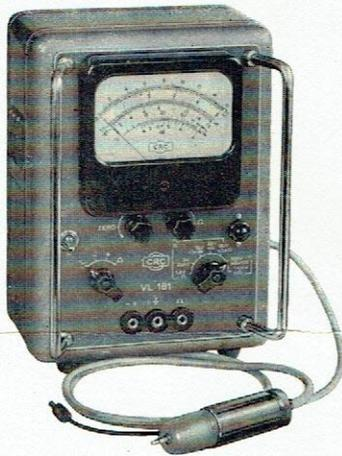
Le multimètre électronique VL 181 est un appareil à fonctions multiples qui peut être employé aussi bien à la mesure des tensions continues et alternatives qu'à celle des résistances de circuits.
