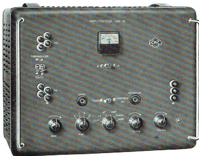
L'AMP 110 est spécialement conçu pour amplifier les signaux de télégraphie reçus sous forme de tensions à fréquences musicales découpées par la modulation télégraphique et les restituer sous la forme classique de courants continus, positifs ou négatifs, découpés au rythme de la manipulation.
