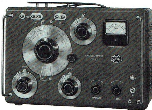
Le CS 52 permet de mesurer en lecture directe et avec précision les coefficients de self induction et les capacités.
