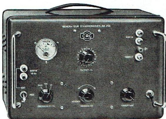
Les Générateurs GE 201 et GE 151 sont des étalons secondaires de fréquences, spécialement conçus pour émettre des signaux tous les 10 kHz dans la gamme 10 kHz - 30 MHz.
