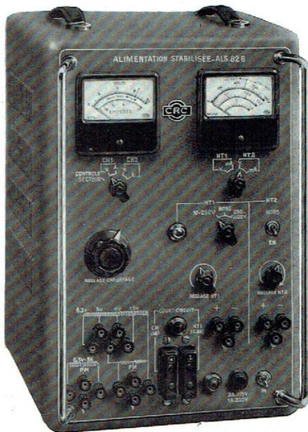
L'ALS 82 B est une source de courants continus et alternatifs, destinée principalement à l'alimentation des tubes à vide en courant de chauffage, en haute tension anodique et en tension de polarisation.
