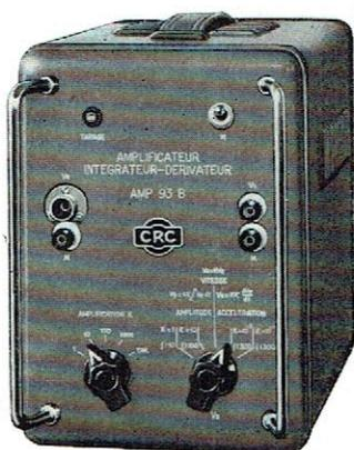
L'AMP 93 B est un amplificateur à gain élevé et étalonné, destiné à l'amplification des signaux basse fréquence de faible niveau.
