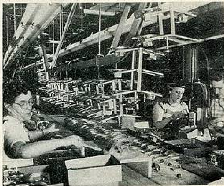
Fig. 4. — Vue d'une chaîne de montage de haut-parleurs. On notera les supports véhiculés par convoyeur et transportant chacun six pièces.
