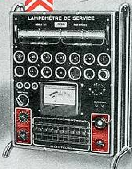
LAMPÉMÈTRE TYPE "751" Tableau tambour à lecture automatique. Mesure les tubes européens et américains de n'importe quel modèle y compris miniatu- res 7 et 9 broches et Rimlock. Un seul support par culot. Sélecteur combiné pour la mesure des lampes à sorties multiples. Échelle de lecture spéciale pour diodes. 16 tensions de chauffage. 1,5 à 117 V. Ajustage du secteur.
