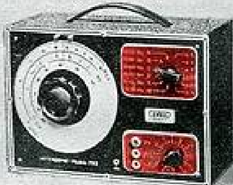
HÉTÉRODYNE "722" 5 gammes H.F. de 80 KHz à 26 MHz. Une gamme M. F. étalée 420 à 520 KHz. Modulation B.F. à 400 pps. Profondeur de modulation 40%. Tension de sortie variable. Une douille pour H.F. de 0 à 0,1 V. Une douille pour H.F. 0 à 1 millivolt. Une douille B.F. 10 V. - Alimentation tous courants. Coffret givré noir.
