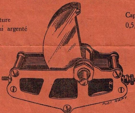
Ce condensateur, d'une très belle présentation, platines oxydées noir bleuté, lames rigides en laiton argenté accouplées, rotor à la masse par lame flexible; montées sur deux barrettes de bakélite, ressort de rappel de jeu donnant une douceur extrême.
