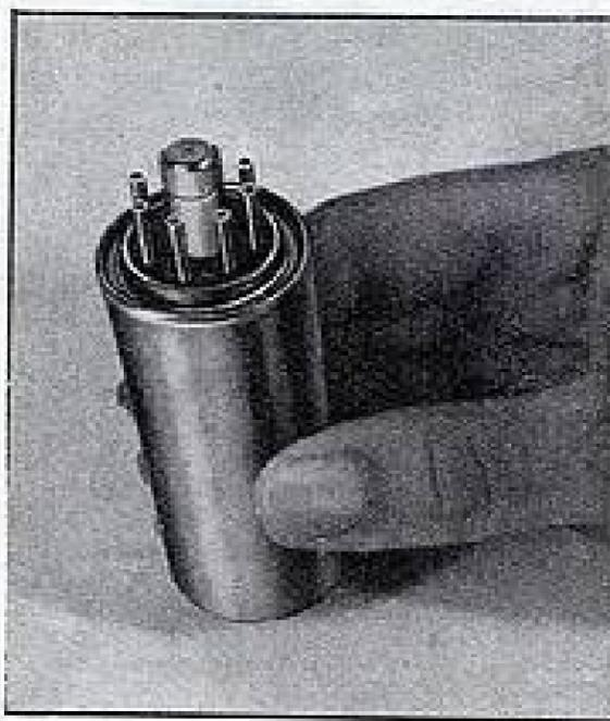
Les traversées individuelles sont constituées par une connexion centrale et un gâlet métallique réunis l'un à l'autre par une perle vitrifiée. Elles sont utilisées pour la mise en boîtier étanche de pièces qui, par leur volume ou leur forme, ne pourraient pas utiliser les boîtiers standard.
