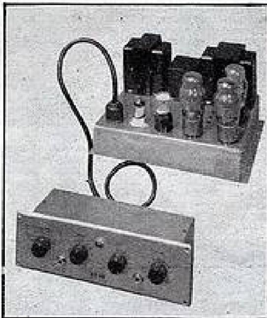
L'amplificateur de puissance, équipé de deux KT 61 en « ultra-linéaire », délivre 10 W avec 2,5 % seulement de distorsion par inter-modulation, la courbe de réponse étant horizontale à  $\pm 0,5$  dB de 20 Hz à 20 kHz.
