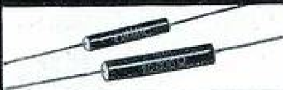
← RÉSISTANCES VITRIFIÉES À COLLIERS APPARENTS ET À COLLIERS NOYÉS SOUS L'ÉMAIL
