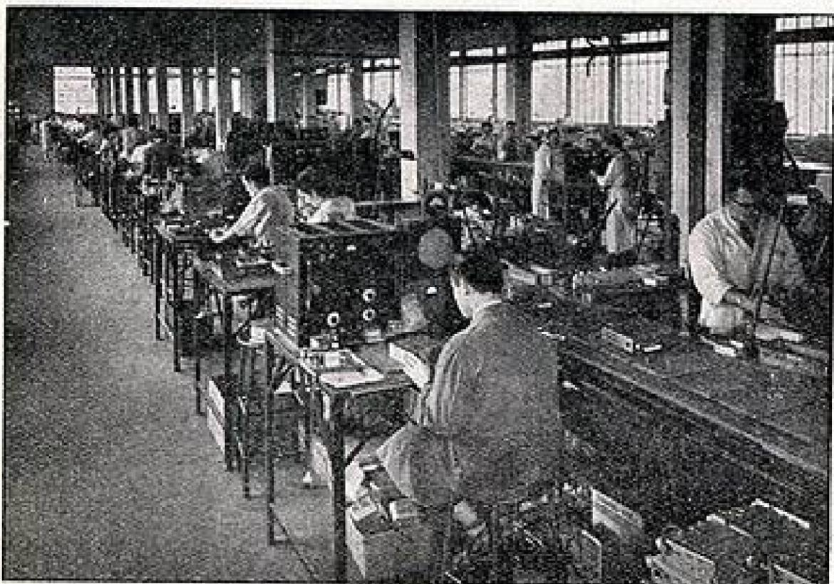
Chaîne de fabrication en série des récepteurs auto-radio à l'usine de la S.F.R.T. (licence Philco).
