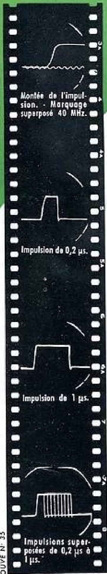
Montée de l'impulsion. - Marquage superposé 40 MHz.
