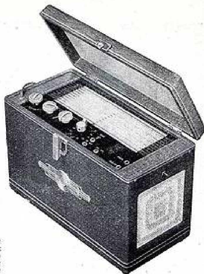
Ce récepteur portable est une version voisine du modèle décrit ci-contre. Comme lui, il est alimenté par secteur alternatif ou continu, ou par accumulateurs.
