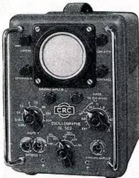
courant continu passe de 0 à 100 kHz, avec une sensibilité de 15 mV eff/cm. Sa base de temps relaxée ou déclenchée a des durées variables entre 1 s et 3  $\mu\text{s}$ . Ses dimensions et son poids réduits en font un oscillographe portatif par excellence.
