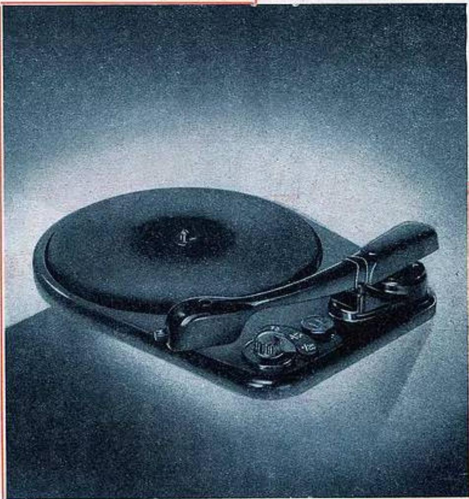
Platine tourne-disques (MC 25) matière moulée. 3 vitesses réglables (33, 45, 78 tours) 110/220 V. alt. 50 P., cellule piéz. réversible (à saphirs incorporés) arrêt automatique avec soulèvement du bras.
