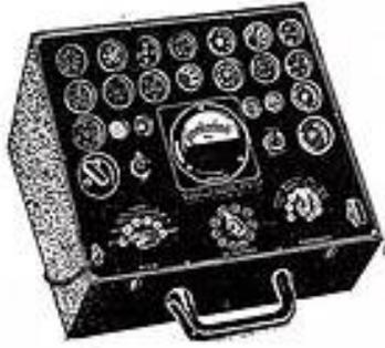
APPAREIL PERMETTANT LE CONTROLE INTEGRAL DE TOUTES LES LAMPES RADIO américaines et européennes, anciennes et modernes, y compris Rimlock, Miniature et Noval.
