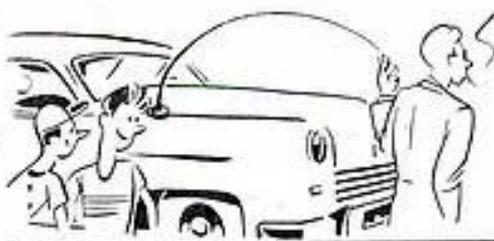
La mise hors circuit du récepteur entraîne la rentrée automatique de l'antenne; de là, protection contre détériorations malignes.
