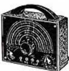
HETERODYNE miniature pour le dépannage, muni d'un grand cadran gradué en mètres et en kilohertz. Trois gammes + une gamme M.F. étalée : G.O. de 160 à 410 KHz - 750 à 2.000 mètres. P.O. de 500 à 1.600 KHz - 190 à 600 mètres. O.C. de 6 à 21 MHz - 15 à 20 mètres. 1 gamme M.F. étalée graduée de 400 à 510 K. Présenté en coffret 100 givré. Dimensions : 200 × 145 × 60. — Poids : 1 kg.
