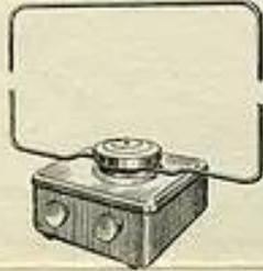
Une bonne réalisation est celle qui est faite avec des composants de qualité, et qui est conçue pour fonctionner dans les conditions les plus défavorables. C'est pourquoi nous avons choisi pour ce montage un cadre métallique en aluminium, qui est à la fois robuste et léger, et qui est capable de résister à la corrosion.
