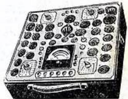
Cet instrument, muni de boutons-poussoirs, est le plus moderne de nos lampemètres. Il permet le contrôle et la lecture du courant d'oscillation des lampes jusqu'à 16 mètres. 400 types de lampes sont mesurables par cet appareil, y compris les tubes tout métal allemands, les lampes à culot Loctal, les « tubes-clefs » Philips, Miniatures, Novals, etc... Encombrement: 365 x 315 x 165. — Poids total: 9 kilos. PRIX : 35.750
