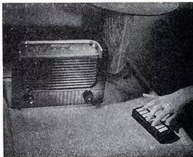
Fig. 6. — Un « piano électronique » miniature à transistor adapté à un poste de radio quelconque.
