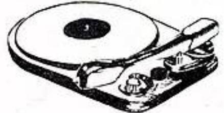
3 VITESSES REGLABLES (33, 45, 78 tours). Plateau en matière moulée. Secteur alternatif, 110 et 220 volts 50 p. Bras très léger avec cellule pézo réversible à saphirs incorporés. Arrêt automatique.
