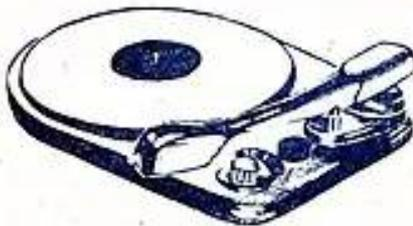
3 VITESSES RÉGLABLES (33, 45, 78 tours). Plateau en matière moulée. Secteur alternatif, 110 et 220 volts 50 p. Bras très léger avec cellule piézo réversible à saphirs incorporés. Arrêt automatique. Encombrement: 340x260x138. Prix ..... 13.900
