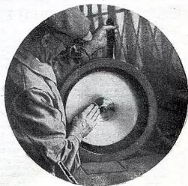
Fig. 7. — La matrice est joïée avant la soudure sur son support. (Documentation Pathé-Marconi, Photo Marcel Arthaud.)
