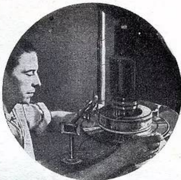
Fig. 6. — Opération de centrage de la matrice (documentation Pathé-Marconi, Photo Marcel Arthaud).
