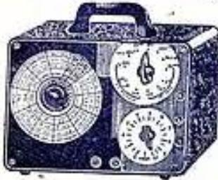
Générateur portable à points fixes. Permet d'effectuer tous les réglages d'appareils récepteurs de radio. Gamme P.O., gamme G.O. Chalutier O.C., O.T.C., MF 455 et 472 kc/s. Parfaite stabilité. Précision supérieure à 1 %. Equipé avec deux tubes rimlock UCH42, UY42. Encombrement : 189 x 95 x 140.
