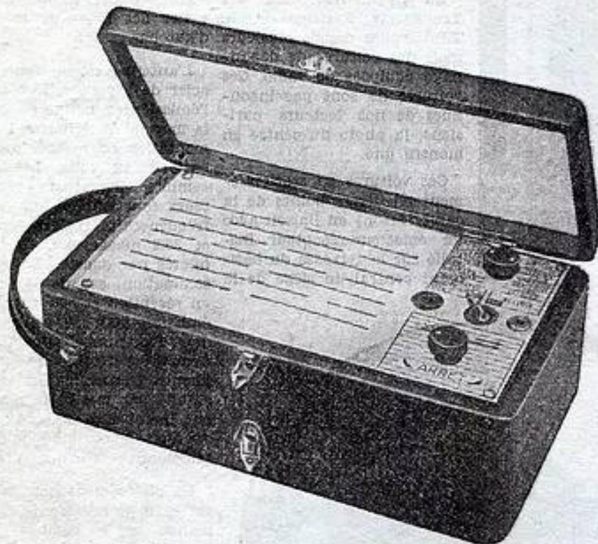
Le petit récepteur que nous allons décrire est destiné à tous ceux qui, bien que désireux de posséder un appareil facile à transporter, hésitent à juste titre à entreprendre la construction d'un changeur de fréquence logé sous un volume extrêmement réduit en raison des difficultés que comporte une telle réalisation : complexité des connexions et nombreux accessoires à faire tenir dans un espace minime, puis, ensuite, alignement et mise au point.
