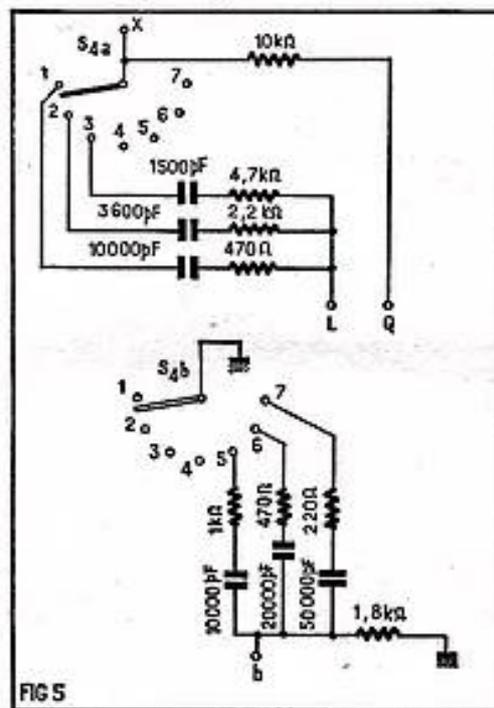
L'élément S<sub>4a</sub> est intercalé dans la liaison entre l'étage 2 (point X) et le circuit de S<sub>4</sub> servant à la correction des basses (points L et Q) qui aboutit au point X<sub>1</sub> entrée de l'étage 3.
