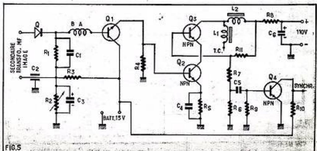
En raison de la valeur élevée de la tension appliquée à  $Q_2$ , un tube cathodique normal de 49 ou 59 cm de diagonale doit convenir à la suite de cet amplificateur.
