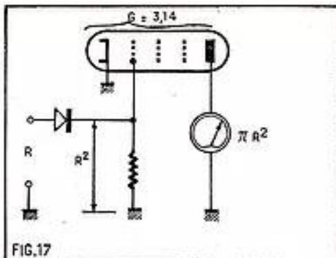
17. — La tension  $R$  appliquée à l'entrée de ce détecteur (toujours quadratique) fournira, à sa sortie, le carré de cette tension et, puisque le gain de l'amplificateur correspond à  $\pi$ , nous aurons finalement la surface du cercle.
