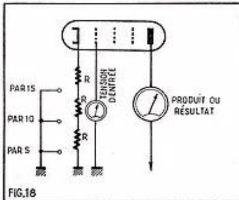
18. — En variant le gain au moyen de la polarisation, on multipliera la tension d'entrée par des facteurs très divers.
