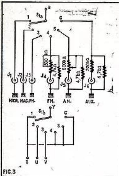
On remarquera qu'en positions FM, AM et AUX on a intercalé des atténuateurs composés d'un pont diviseur de tension. Ceux des positions AM et FM sont à réduction réglable de la tension grâce aux potentiomètres de 500 kΩ. Ces diviseurs de tension se justifient par le fait que les sources radio fournissent des tensions de l'ordre du volt, donc de 20 à 100 fois supérieures à celles fournies par un pick-up à réluctance variable ou un microphone.
