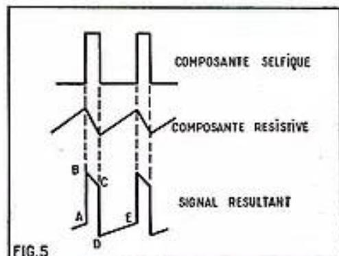
5. — Le signal apparaissant aux bornes de l'ensemble self + résistances résumera, en quelque sorte, chacune des composantes.
