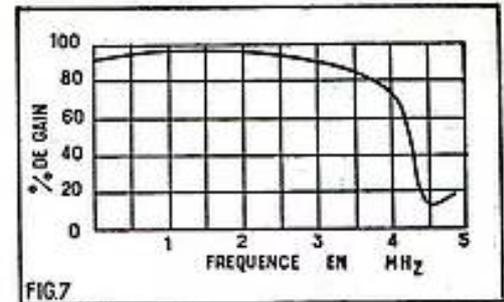
mais sans découplage ce qui crée une contre-réaction pour ce transistor monté en base commune.
