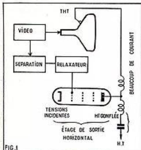
1. — L'étage de sortie horizontal a la double mission de fournir aux bobines de déviation des courants en dent de scie et de fabriquer indirectement la très haute tension.
