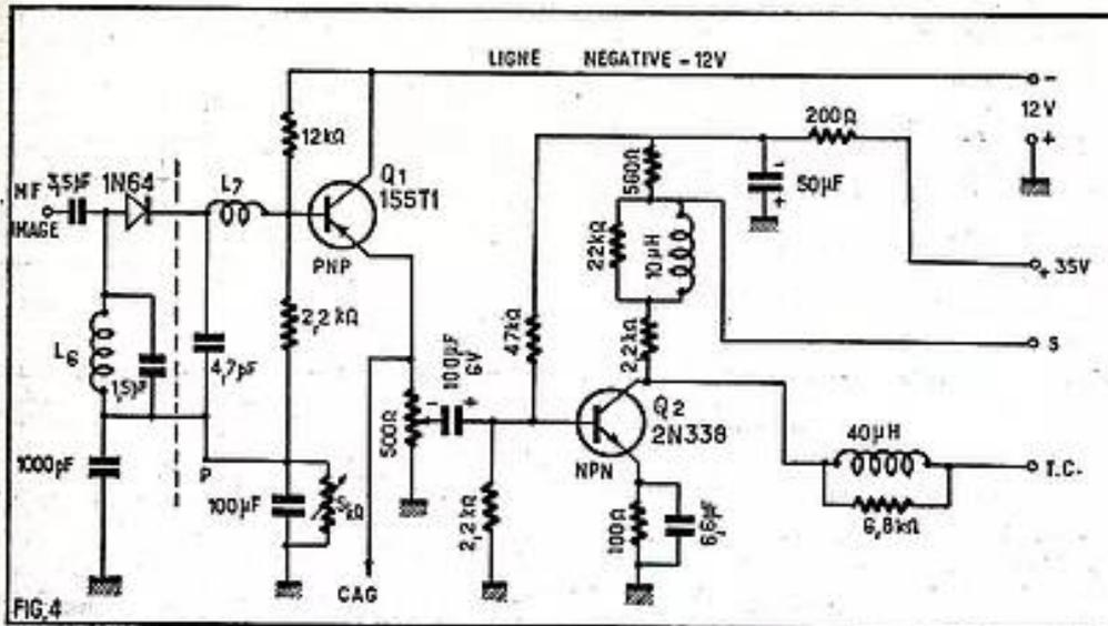
Dans ce circuit la capacité d'entrée est 4,7 pF + capacités parasites et la capacité de sortie à droite de L<sub>2</sub>, constituée par des capacités parasites et celle d'entrée du transistor monté en collecteur commun.
