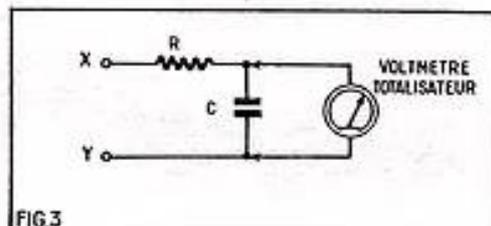
3. — Lire la tension atteinte aux bornes de C, au bout d'un temps égal à la constante de temps, c'est être renseigné sur l'importance de la tension présente entre X et Y.
