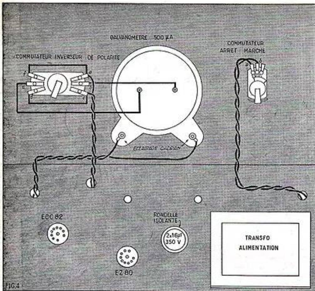
On connecte respectivement les broches 1 et 7 du support EZ80 aux extrémités de l'enroulement HT du transfo d'alimentation. On soude le cordon d'alimentation
