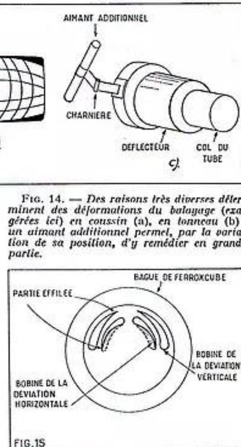
FIG. 15. — Les bobines en forme cosinusoidale, améliorent en particulier la focalisation dans les coins de l'écran.
