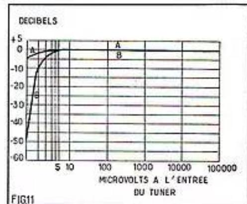
La figure 11 donne deux courbes. La courbe A montre le niveau du signal de sortie avec le commutateur de réglage silencieux en position Ouvert, en fonction de la tension en microvolts à l'entrée du tuner. On peut voir que ce niveau se révèle constant à partir de 5 µV et qu'il ne descend qu'à - 5 dB lorsque le signal HF appliqué à l'entrée est de 1 µV.
