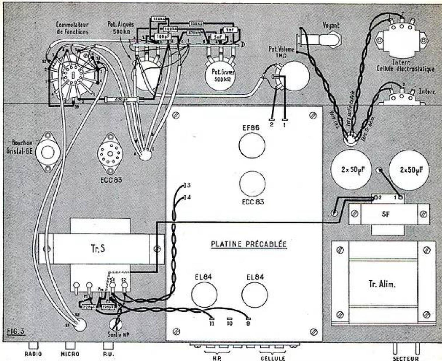
un condensateur de 100 pF entre les cosses *b* et *c*, un de 5 nF entre les cosses *g* et *h* et un autre de 5 nF entre les cosses *h* et *i*.
