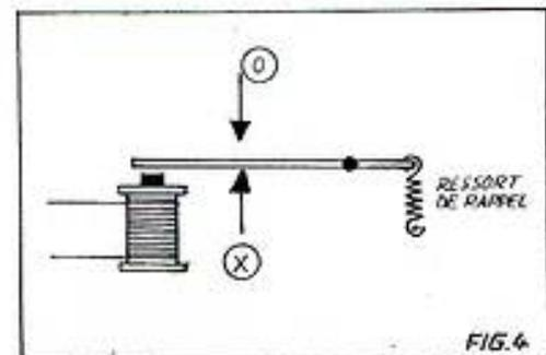
FIG. 4. — Un relais dont la palette serait en mesure d'établir deux contacts différents suivant sa position, peut très bien jouer ce rôle de traducteur.
