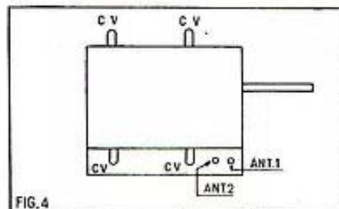
On peut alors voir les deux œillets de contact d'antenne : antenne 1, antenne 2, aboutissant au primaire du transformateur d'entrée.
