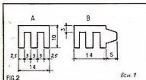
de la figure 2. Il comporte 5 éléments du type A et 1 du type B. A noter qu'une tôle est prolongée d'un côté et assure la fixation du transformateur dans le montage. Le bobinage s'effectue sur un mandrin de papier. Il comporte environ 500 spires de fil émaillé 4/100 avec une prise médiane. La fragilité de la carcasse en papier
