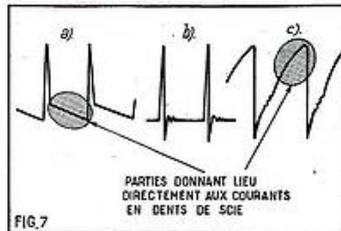
FIG. 7. — Par suite de la présence de diverses capacités et selfs, les tensions ne ressemblent guère à des dents de scie.
