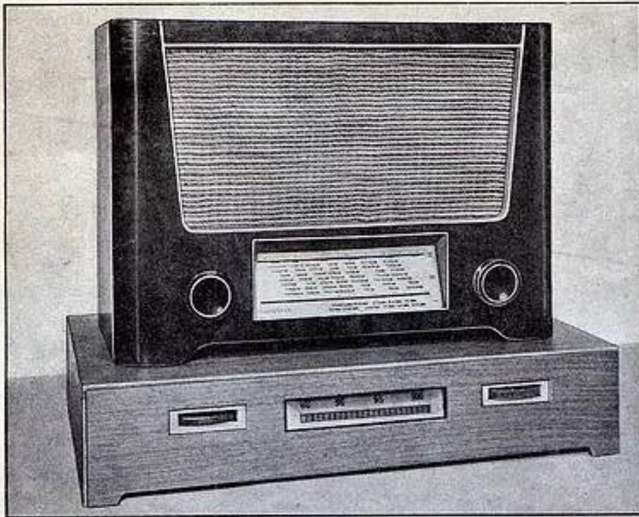
Fig. 11. — Lorsque le récepteur à transformer est trop petit pour contenir l'adaptateur, il reste cette solution...
