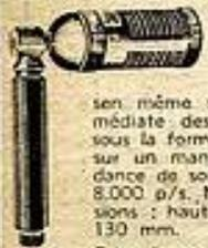
Basé sur un principe nouveau, ce microphone est totalement insensible aux bruits ambiants et possède l'avantage d'éliminer l'effet Larsen même s'il est placé à proximité immédiate des haut-parleurs. Il se présente sous la forme d'un cylindre oxydé et monté sur un manche en matière moulée. Impédance de sortie 10 ohms. Fréquences 100 à 8.000 p/s. Niveau de sortie 76 dB. Dimensions : haut. 150 mm, diam. 40 mm., long. 130 mm.
