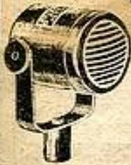
Microphone dynamique type à pression, comporte une chambre acoustique à matelas d'air et un dispositif compensateur qui uniformise leur sensibilité entre 50 et 10000 p/s. La courbe de réponse varie peu avec l'angle d'attaque, une différence d'efficacité entre l'onde avant et arrière de 5 déc., soit un rapport de tension de 1 à 17, impédance de sortie 10 ohms, fréquences 50 à 10.000 p/s. Dimensions : haut. 155 mm, diam. 60 mm, prof. 85 mm. Sortie sur 3 bornes.
