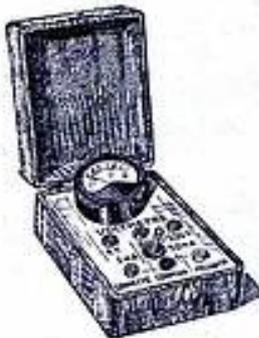
Fig. 14. — Ce contrôleur se trouve protégé par un coffret, ce qui facilite son transport et son emploi.
