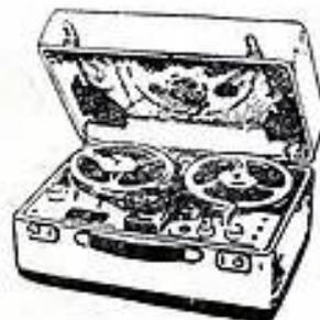
Trois vitesses, 4,75, 9,5, 19,5 cm/s. Compteur de tours. Surimpression. Stop instantané. Double pistes. Entrées pour micro PU. Contrôle visuel de la modulation par œil magique. Partie radio. 5 gammes d'ondes dont 1 PD - GO et 3-DC. Haut-Parleur haute fidélité incorporé dans le couvercle. Coffret bois luxueusement gainé.
