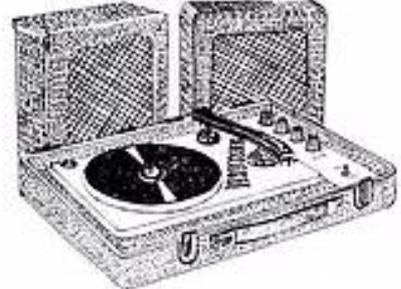
Mallette se séparant en 2 éléments. Partie amplificateurs comportant 2 amplis de 5,5 watts avec balance contrôle tonalité aiguë et grave équipée d'une platine 4 vitesses avec tête de lecture utilisation en stéréo ou mono sans modification. Deux couvercles détachables, contenant deux haut-parleurs de 21 cm. haute-fidélité. Alimentation secteur alternatif 110-220 volts. Dimensions : 470 x 345 x 210.
