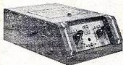
Un préamplificateur microphonique séparé à alimentation autonome pouvant être utilisé, soit comme mélangeur PU-microphone, soit comme préamplificateur de ligne pour microphone placé à longue distance.
