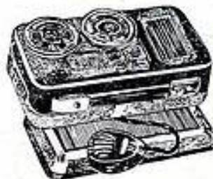
Importation allemande. Alimentation : 4 piles blindées 1,5 V Standards permettant un fonctionnement d'environ 50 heures. Bandes magnétiques extra-minces de 120 m permettant des enregistrements double-pistes 2<sup>e</sup> fois 22 minutes à 9,5 cm/s. Sortie pour amplification par poste Radio, amplificateur, etc.
