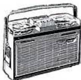
Magnétophone. 4 pistes-vitesse de défilement 9,5 cm/s. 4 lampes. Bobines de 100 ou 130 mm. Durée 4 heures. Gamme de fréquences 60 à 14 000 c/s. Haut-parleur de 17 cm. Puissance 1,5 W. 3 entrées Micro : 0,2 mV. FU 130 mV. Secteur alternatif 110 et 240 volts, 50 périodes. Dimensions : Hauteur 230 mm. Longueur 340 mm. Profond 125 mm. Poids 6 kg environ. Livré avec bande et microphone.
