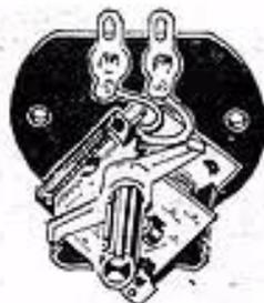
FIG. 36. — L'échappement à moteur caoutchouc n° 13.
