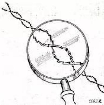
FIG. 5. — Vue grossie du fil de la scie de poche Tubest (double sens de coupe).
