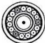
FIG. 31. — L'intérieur d'un câble coaxial.
