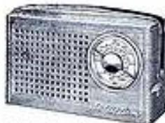
En utilisant notre ensemble câblé et réglé sur circuit imprimé comprenant : les bobinages oscillateurs et MF, cadre surmoulé incassable, résistances, condensateurs ; variable, chimiques, papier, céram, potentiomètre avec inter, commutateur d'ondes POGO, driver 6 transistors + diode, fils de raccordement pour HP alimentation, prise d'antenne auto.
