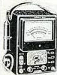
Mesure des tensions continues en 7 gammes. Mesure des résistances en 7 gammes. Mesure des tensions alternatives BF et HF de 50 Hz à 50 MHz en 5 gammes. Les surtensions éventuelles sont sans dommage pour l'appareil. Grande stabilité par montage symétrique à contre-réaction totale. Alimentation secteur alternatif de 110 à 240 V. Présentation coffret bakélite avec poignée cuir. Bequille pour lecture dans la position inclinée. Dimensions 207 x 155 x 106.
