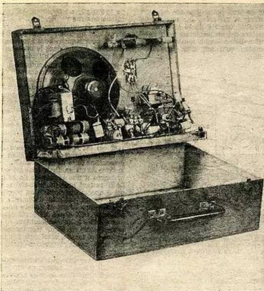
FIG. 3. — Maquette prototype ayant servi à étudier et mettre très correctement au point le montage en reflex, d'un transistor haute fréquence à circuit accordé plus 2 BF. (Doc. Bonny à Libourne.)
