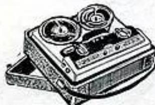
Modèle TK6 de luxe. Importation italienne. Haute fidélité. 4 pistes. Deux vitesses 19 cm/s et 9,5 cm/s. Puissance de sortie 3 watts alimentation secteur alternatif 110 et 220 volts. Touche pour surimpression. Boutons. Tonalité et mixage. Indicateur niveau d'enregistrement. Compte-tours avec remise à zéro. Livré avec bande et microphone.
