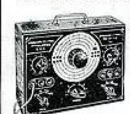
Générateur le plus complet sous un faible volume et courant (sans trous) de 100 kc/s à 42 Mc/s 3 000 m à 7,15 m en 6 gammes. Chaque appareil est étalonné séparément à partir d'un std de fréquence à quartz. Précision : 1 % pour toutes les gammes. Présenté en coffret
