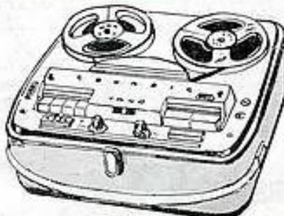
Enregistreur de haute qualité sur secteur 110-220 V. Trois vitesses : 19 cm/s, 9,5 cm/s, 4,75 cm/s, 4 pistes (aux normes internationales), dépoussiéreur de bande incorporé. Contrôle de niveau d'enregistrement. Gamme de fréquence 40 à 18 000 HZ, 40 à 15 000 HZ, 40 à 9 000 HZ. Compteur de repérage avec remise à zéro, bobine de 160 mm. Dimensions : 410 x 360 x 195 mm. Poids environ 12,5 kg. Prix MB ..... **1 250 F**
