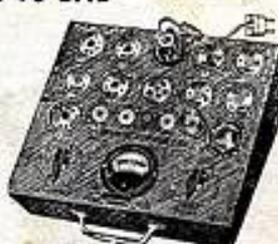
Une seule manette permet de soumettre la lampe successivement à tous les essais et mesures. Les résultats sont indiqués automatiquement par un milliampèremètre à cadre mobile avec cadran à 3 secteurs : Mauvaise Douteuse Bonne. Fonctionne sur secteur alternatif 110 et 130 V. Coffret oultre 26 x 22 x 12 cm. Poids 2 kg.
