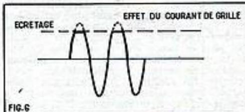
FIG. 6. — La présence d'un courant de grille dans un circuit résistif amènerait cet effet d'écrêtage.
