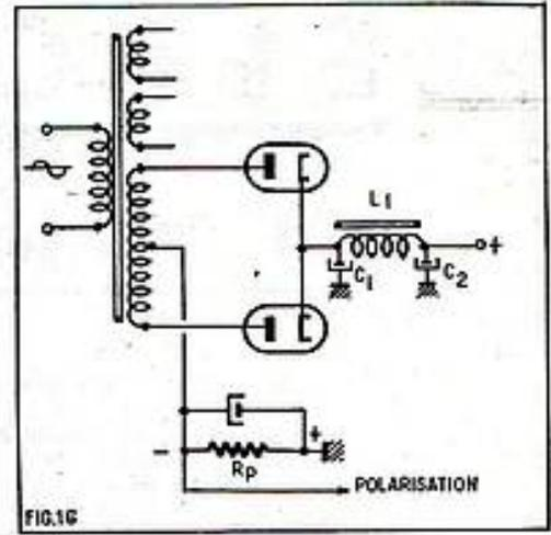
FIG. 16. — Ce montage constitue une polarisation semi-fixe pour peu que la consommation de l'étage final représente la plus grande partie de la consommation totale.
