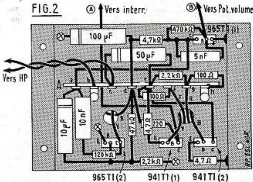
circuit collecteur est donc lui aussi en opposition de phase. Ces deux courants BF empruntent la dérivation constituée par le 50  $\mu$ F et la bobine mobile du HP où il s'ajoutent. On obtient donc par des moyens différents le même résultat qu'avec le push-pull classique. La bobine mobile du HP a une impédance de 28  $\Omega$ .
