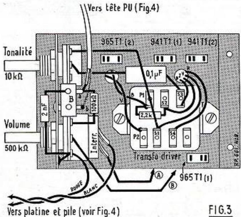
mètres (500 000  $\Omega$  avec interrupteurs et 10 000  $\Omega$ ). Entre ces deux organes on soude le relais B. Enfin, sur le dessus du châssis on monte le transfo driver.
