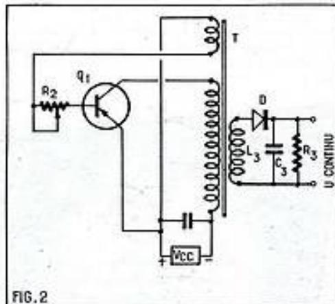
Si, maintenant, l'interrupteur S est ouvert, l'énergie du champ magnétique emmagasiné dans les bobines est libérée et il se produit une impulsion de tension de signe inverse. La diode est alors conductrice et C se charge jusqu'à ce qu'il ait emmagasiné toute l'énergie disponible.
