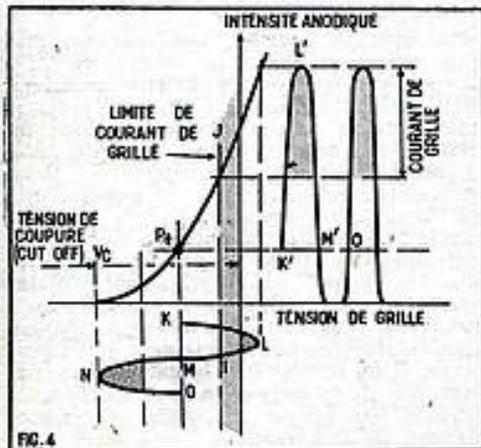
FIG. 4. — En classe AB2 l'amplitude d'attaque est telle que le point de fonctionnement se déplace d'un côté dans les régions où se manifeste le courant de grille ( $I_{sg}$ ) et celle où le courant anodique est coupé  $V_c$ .
