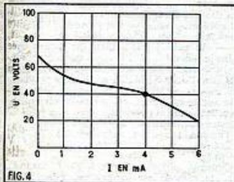
On peut ainsi obtenir 55 V environ sous 1 mA, 40 V sous 4 mA, 30 V sous 5 mA et 20 V sous 6 mA.
