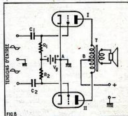
FIG. 8. — Schéma de principe d'un montage symétrique.
