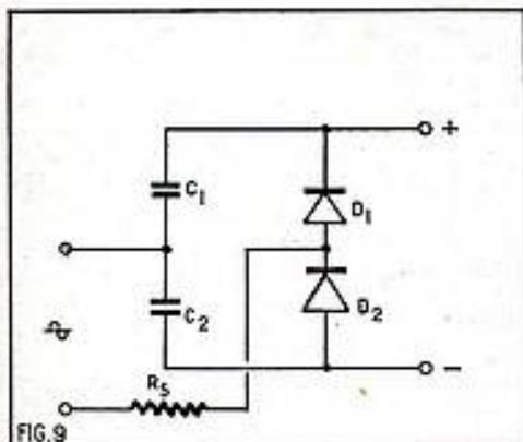
la tension moyenne redressée sera de 30 V et les courants moyens redressés de 40 mA à 25° C et de 20 mA à 55° C.
