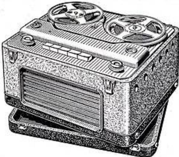
Type semi-professionnel à commande électromagnétique par clavier, arrêt et départ instantanés par embrayage ou débrayage électromagnétique ne demandant aucune tension à la bande. 2 ou 3 vitesses 38 - 19 - 9,5 cm/seconde, pouvant recevoir 2, 3 ou 4 têtes. Possibilité de commandes à distance. Compteur horaire à remise à zéro incorporé.
