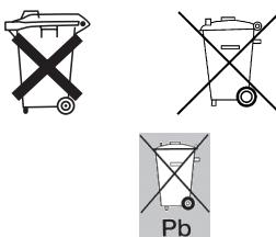
Les piles et accumulateurs qui contiennent des substances toxiques sont caractérisés par les symboles ci-contre qui indiquent l'interdiction de jeter les piles et accumulateurs dans les ordures ménagères.
