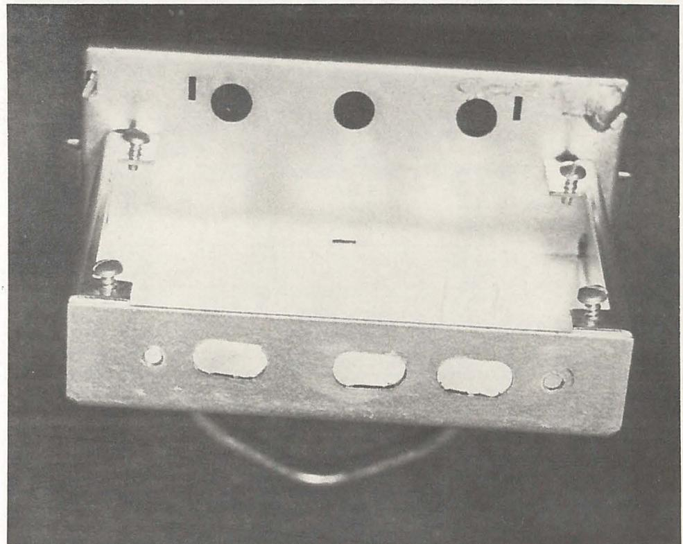
Figure 5 : 1 opération - perçage de la tôle
