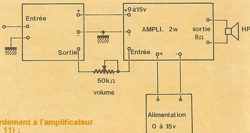
Raccordement à l'amplificateur (figure 11) :
