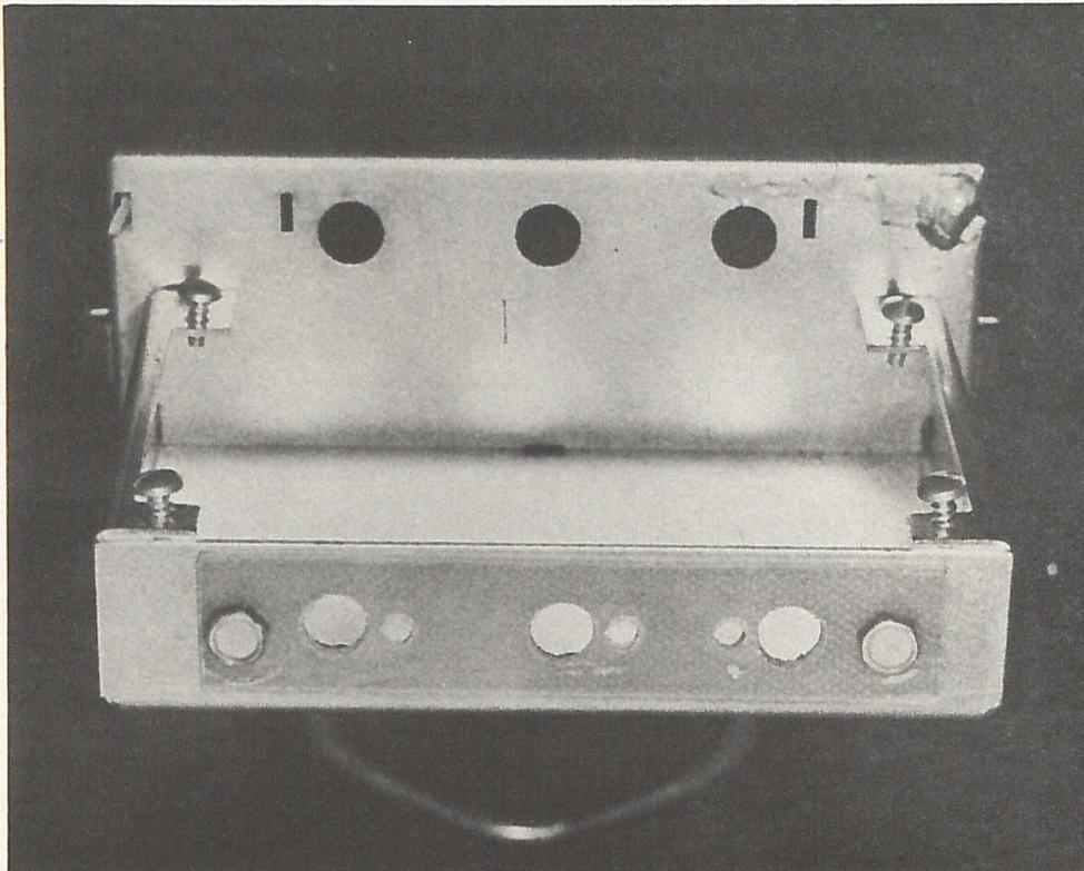
Figure 6 : 2<sup>e</sup> opération - perçage et montage du support isolant
