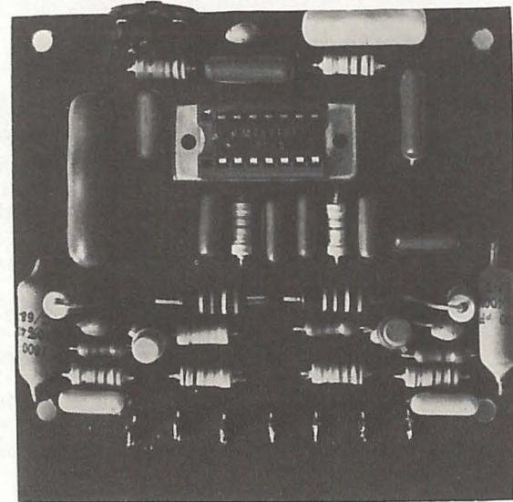
phase agit directement sur la fréquence du VCO et permet ainsi la reconstitution d'une porteuse à 38 kHz, parfaitement synchronisée avec le signal pilote.
