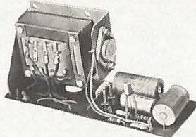
Redressement par 2 diodes (40J2), stabilisation et régulation par transistors SFT212 et AC125, sortie 24 V régulé stabilisé, sortie Intermédiaire 18 V, alim. 110/220 V, dim. approx. 155 x 55 x 70 (h) mm.
