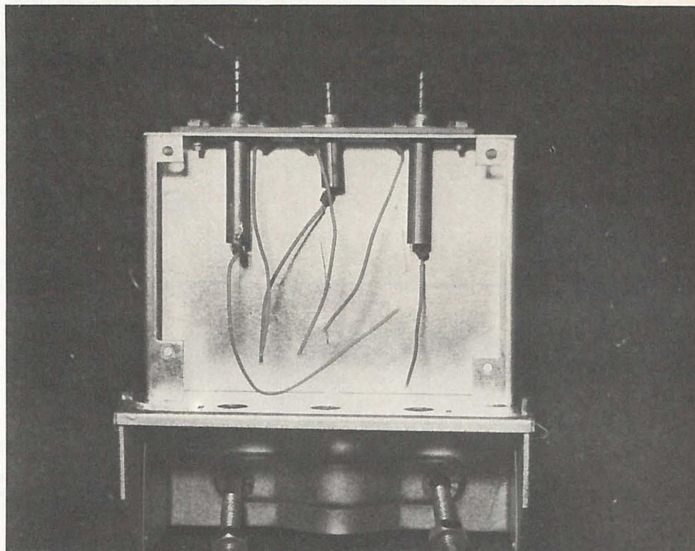
Figure 8 : 4 opération - soudage des fils de connexion
