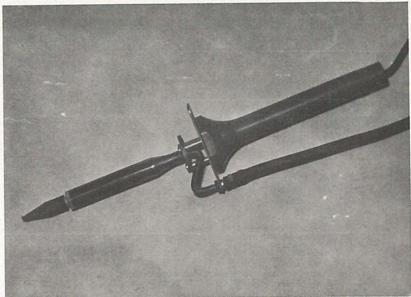
Le fer à dessouder « Toutélectric » type Norma dont la poire a été remplacée par un tube caoutchouc relié au compresseur.
