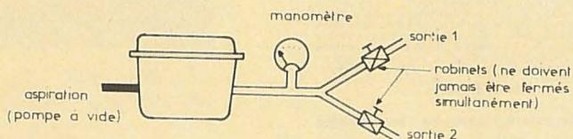
Figure 2 : Possibilité d'équipement de la sortie d'air comprimé.
