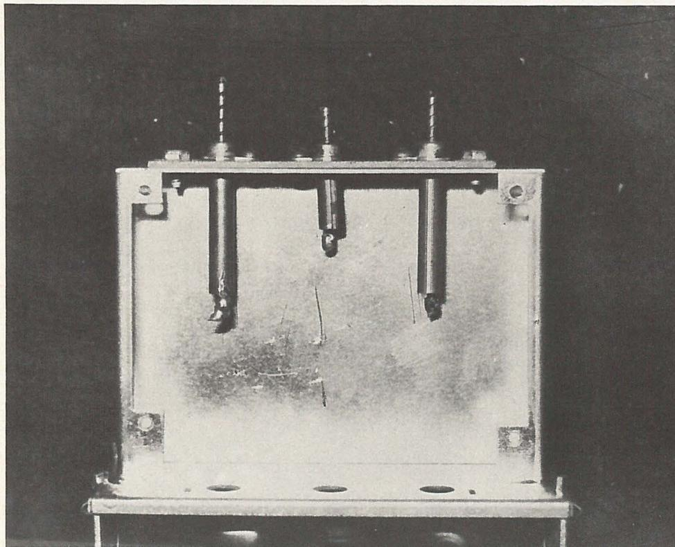
Figure 7 : 3<sup>e</sup> opération - Montage des trimmers
