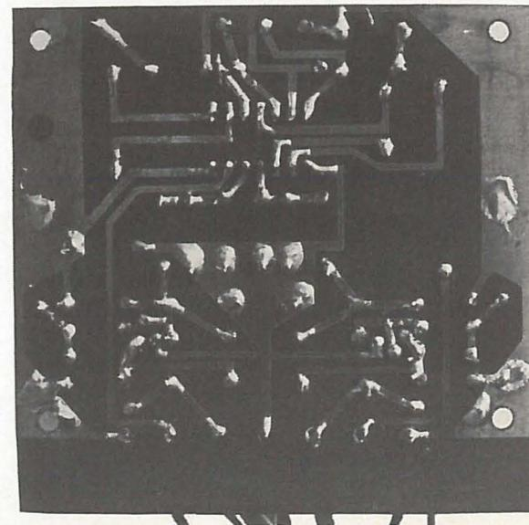
phase (borne 11), cette faible valeur permet une atténuation des fréquences inférieures à 19 kHz. Entre les bornes 8 et 9 d'une part, et 12 et 13 d'autre part seront insérés les éléments RC des filtres associés aux détecteurs de phase ; le premier comprend un seul condensateur de 220 nF, le second un réseau plus complexe (1 k $\Omega$  ; 0,22  $\mu$ F ; 0,47  $\mu$ F).
