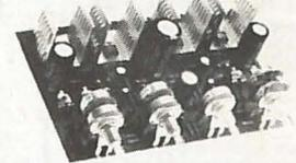
**MA 33 S.** Module ampli Hi-Fi stéréo 2 x 33 W. Sortie 8/16 Ω. Entrée 50 K. Réponse 30-18 000 Hz. Aliment. 2 x 26 V, 1 A. Réglages : Volume, basses, aigus (185 x 145 x 60).
