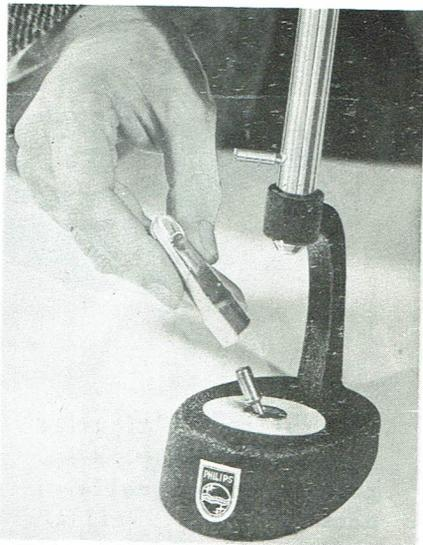
Après quelques essais, la mise au point sera très aidée. Il est bon de se souvenir que chaque mouvement de la tête de pick-up sous l'objectif se traduit par un mouvement de l'image dans le sens opposé.
