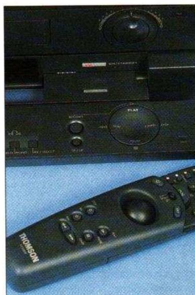
Les commandes du magnétoscope apparaissent une fois la face avant ouverte. Thomson joue sur la forme circulaire des commandes, pour la molette, les touches de défilement ou la boule de la télécommande.
