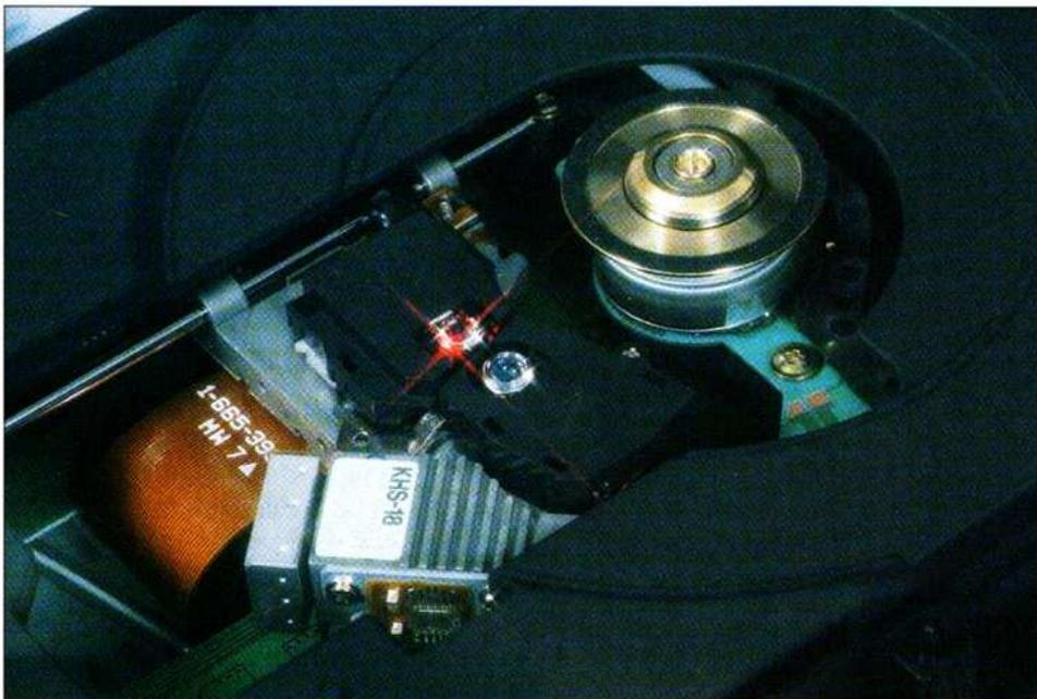
Le platine Sony utilise un chariot équipé de deux têtes laser. Au fond, on aperçoit le moteur de rotation sans collecteur, à commutation électronique.
