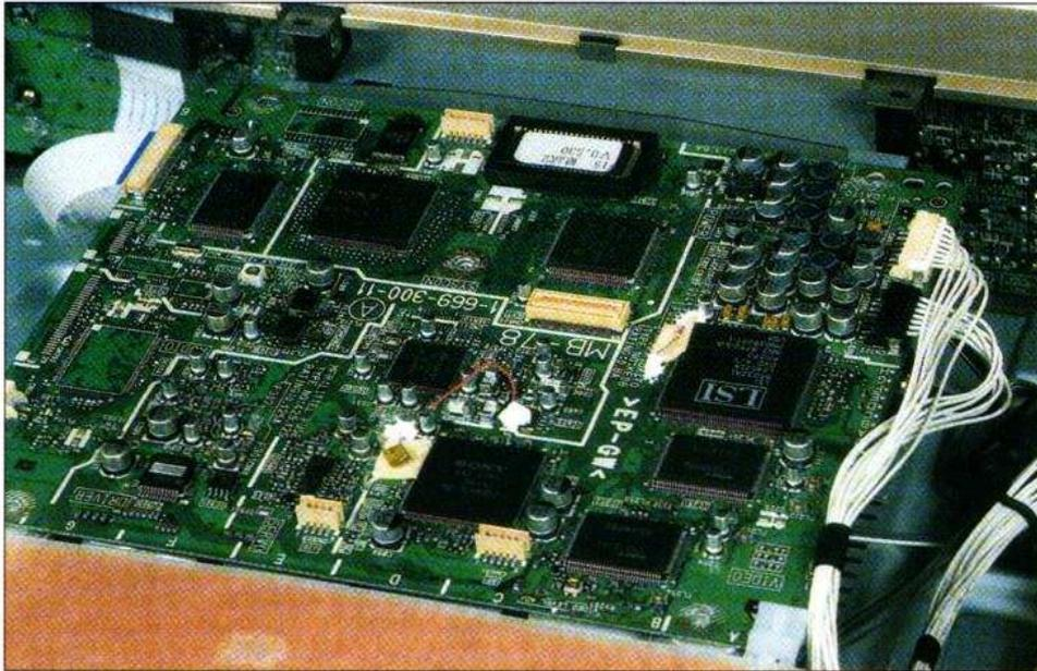
La platine électronique du DVP-S715, elle reçoit de nombreux circuits intégrés, on n'en voit ici que sur une face.
