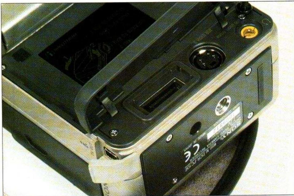
*Sony installe le connecteur IEEE 1394 sur l'avant de son caméscope. Un panneau s'ouvre sur le côté pour brancher le câble d'alimentation ; on y trouve une sortie S-Vidéo et un jack multiple audio stéréo et vidéo.*
