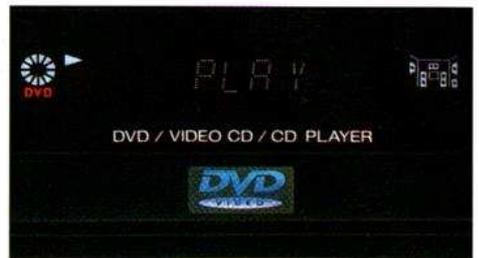
**A droite de l'afficheur, un logo signale la disponibilité d'un signal 5.1. Au-dessous, il peut être mentionné 24 bits 96 kHz ! L'afficheur peut aussi préciser le type de signal audio par un affichage défilant. A gauche, un autre logo signale que le disque tourne.**
