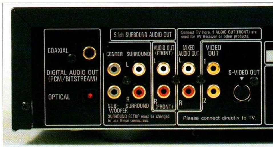
Le panneau de raccordement et ses multiples sorties. En audio, nous avons les 6 sorties des systèmes 5.1, une autre paire sort les signaux mélangés. La sortie optique et numérique s'accompagne d'une coaxiale. En plus, deux prises SCART seront à votre disposition.
