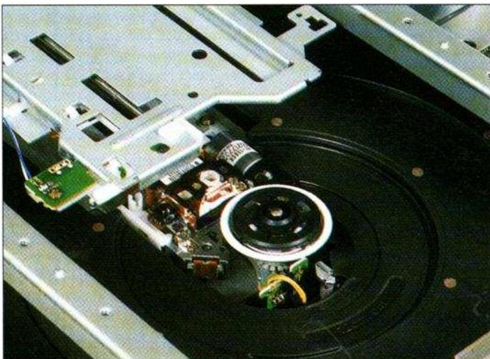
*Le chariot laser de lecture des Laserdisc et des CD se promènera aussi sur le rail supérieur. Un autre chariot laser, ici au garage, s'occupera des DVD.*
