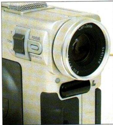
*Sony se procure son zoom en Allemagne ; au dessous, il installe un puissant émetteur infrarouge qui transmettra les signaux audio et vidéo au téléviseur. La bague d'objectif sert à la mise au point, elle entre en service sitôt la touche focus pressée.*
