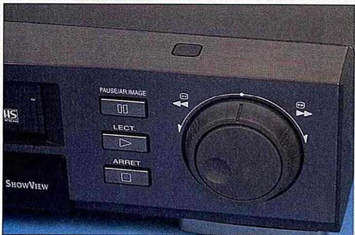
Au-dessus de la molette de recherche, une fenêtre émettra des signaux en direction du récepteur satellite que le magnétoscope commandera.
