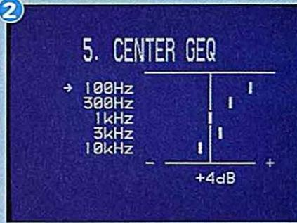
**2.** Le correcteur graphique présente une allure penchée, on promènera la flèche verticalement pour changer de fréquence.
