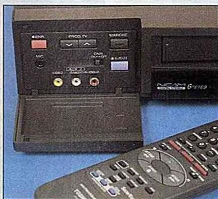
L'interrupteur DNR est là pour les incrédules, il vous permet de voir la différence. La télécommande reste classique, avec des touches normales réunies en diverses sections.
