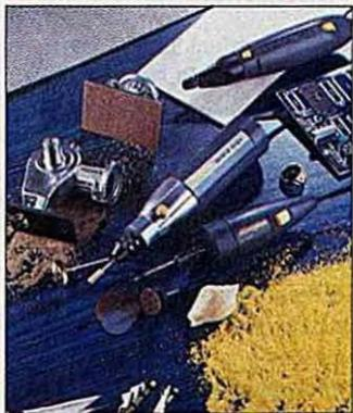
Avec plus de 73 références, la gamme Miniplex de Triplex permet bien des petits travaux d'électronique, comme le perçage des circuits imprimés, mais aussi des travaux de décoration (gravure sur verre ou sur bois), la petite mécanique, la bijouterie fantaisie, la restauration des vieux objets, le maquettisme...
