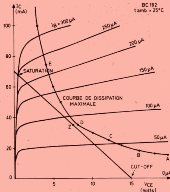
Fig. 8. — Tracé de la droite de charge sur le réseau  $I_C/V_{CE}$  d'un transistor.
