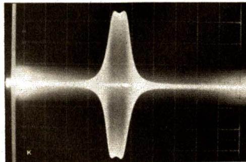
Photo K. - Courbe de réponse de T<sub>2</sub> et T<sub>3</sub> dans le cas de la réception de 72 MHz. Noter la courbe à deux bosses du surcouplage donnant une bande passante de 500 kHz (500 kHz par division).
