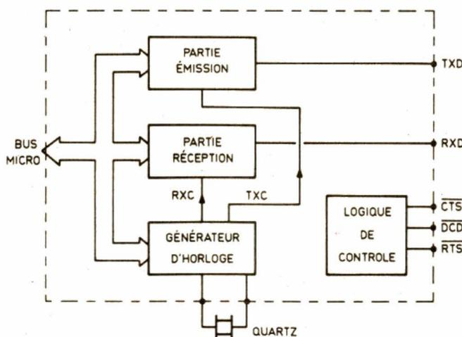
Fig. 1. - Synoptique simplifié du SY 6551.
