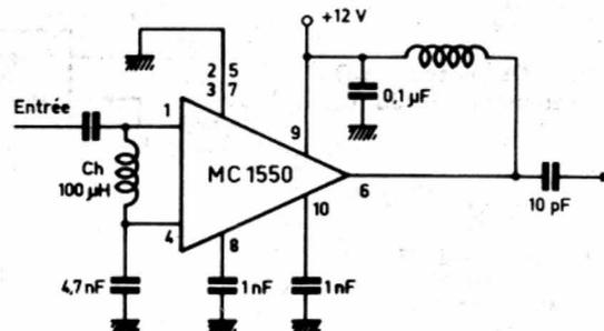
Fig. II-27. - Etage amplificateur, jusqu'à 150 MHz.
