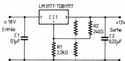
Fig. 4. — Schéma de principe du module d'alimentation.
