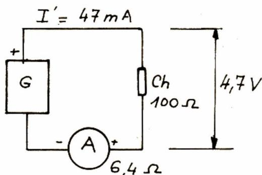
Fig. 6. - L'ampèremètre perturbe le circuit.
