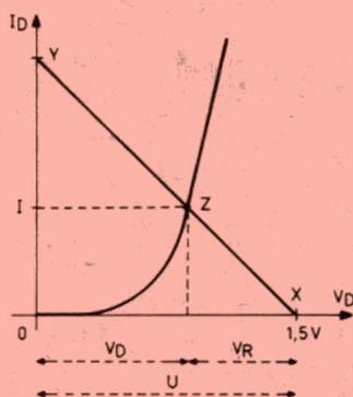
► Fig. 4. — Si  $U$  augmente, la droite de charge nous donne les nouvelles valeurs de courant et de tension.
