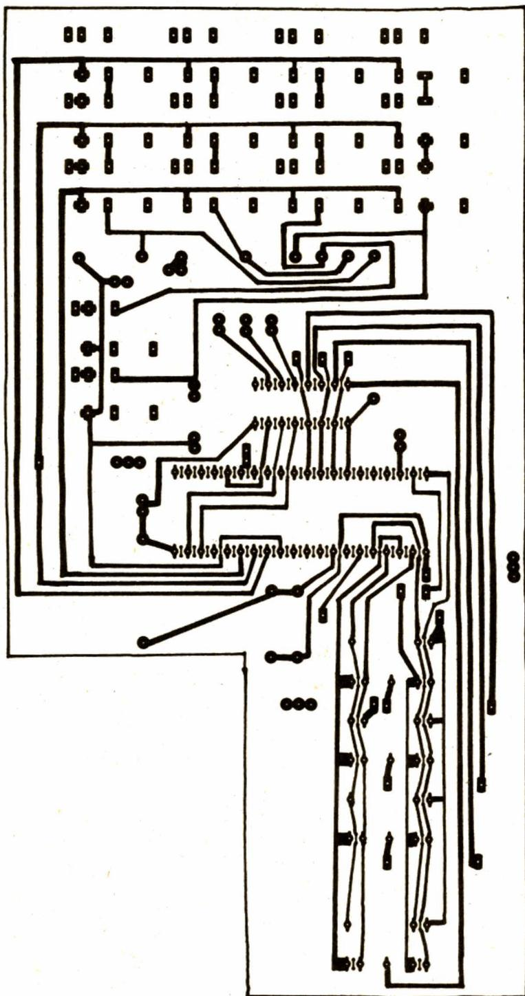
Fig. 4. - Circuit imprimé principal, vu côté cuivre, échelle 1.
