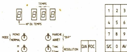
Fig. 9. - Disposition et fonctions des commandes de la face avant.
