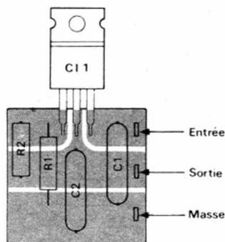
Fig. 7. — Implantation des composants de l'alimentation.
