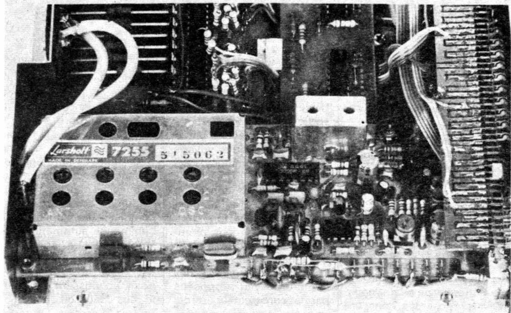
Photo A. — Gros plan sur le module MF du tuner avec, à gauche, la partie RF blindée. Le circuit imprimé est à double face. Plusieurs composants sont directement soudés sur les cosses de sortie.
