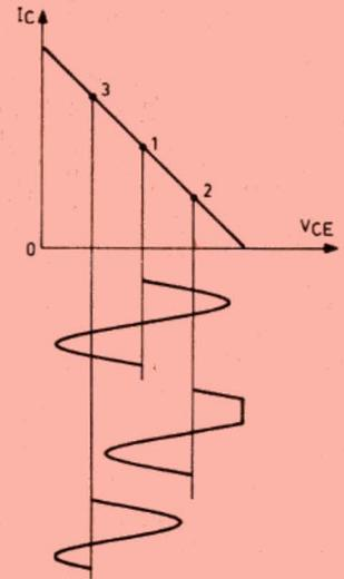
Fig. 10. — Le point de fonctionnement doit être situé au milieu de la droite pour avoir le maximum de tension de sortie sans distorsion.
