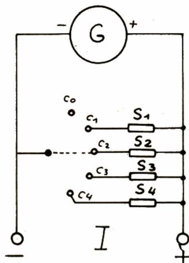
Fig. 3. - Obtention de plusieurs calibres, solution A.
