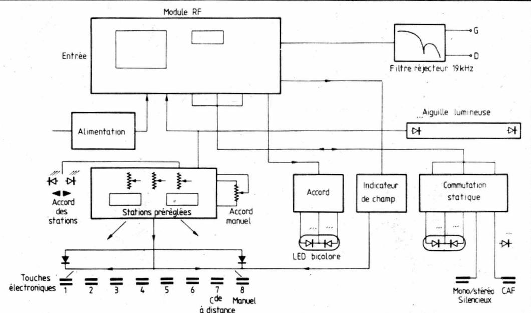
Fig. 3. — Synoptique du tuner de la mini-chaîne.
