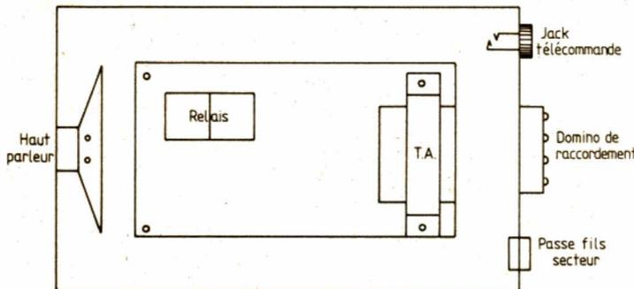
Fig. 8. - Disposition des éléments dans le fond du boîtier.
