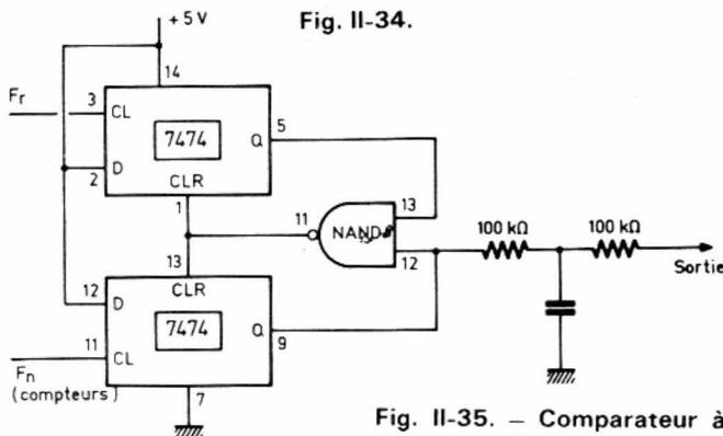
Fig. II-35. - Comparateur à deux bascules et une porte NAND.
