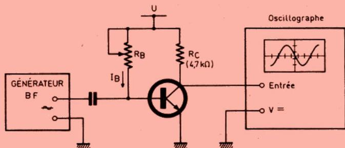
Fig. 11. - Contrôle à l'aide d'un oscilloscope.
