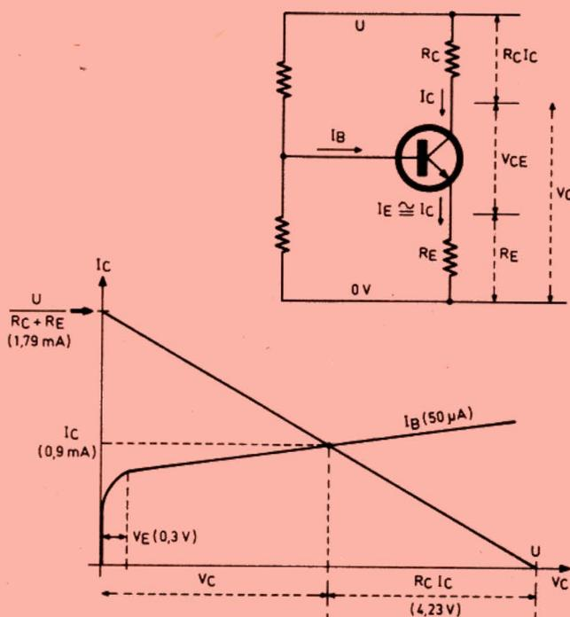
Fig. 13. - La résistance  $R_C$  doit être prise en compte pour le tracé de la droite de charge.
