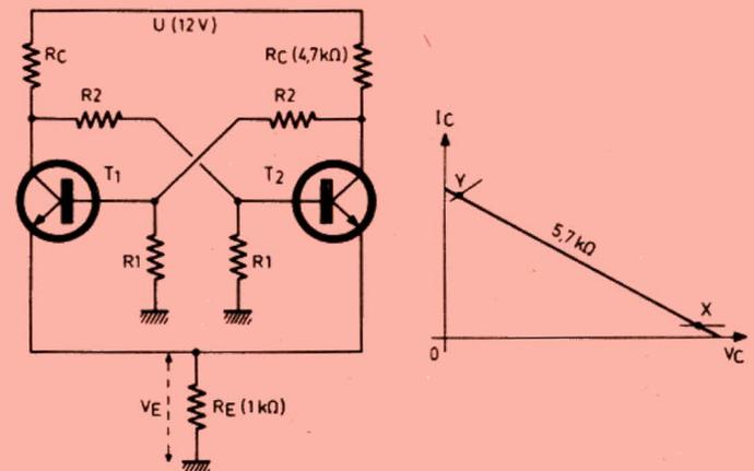
Fig. 16. - Montage bistable et sa droite de charge.
