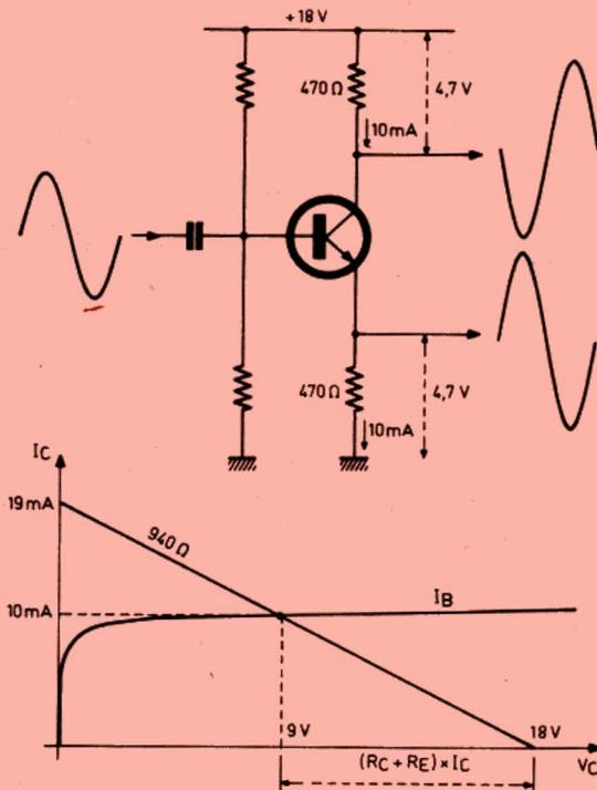
Fig. 14. - Circuit déphaseur et sa droite de charge.
