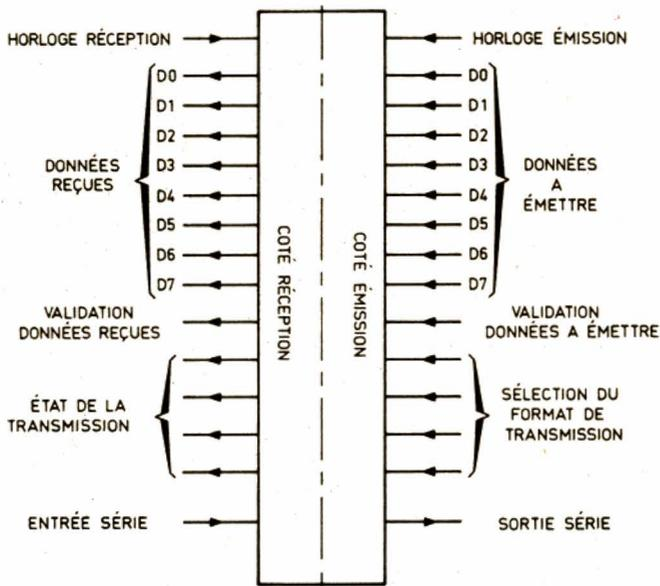
Fig. 2. - Synoptique détaillé d'un UART classique.
