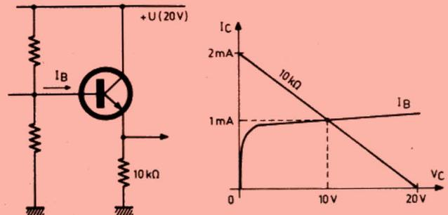
Fig. 15. - Adaptateur d'impédance et sa droite de charge.
