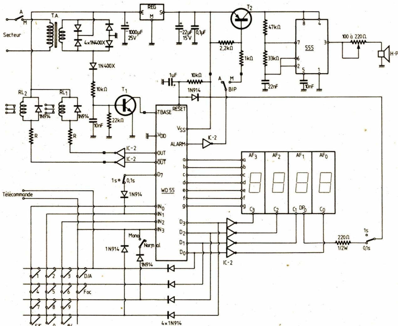
Fig. 1. - Schéma complet de notre montage.
