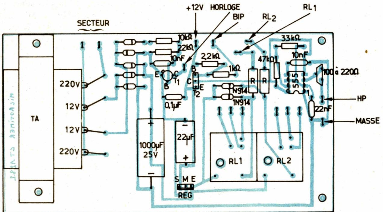
Fig. 5. - Implantation des composants sur le circuit de l'alimentation.
