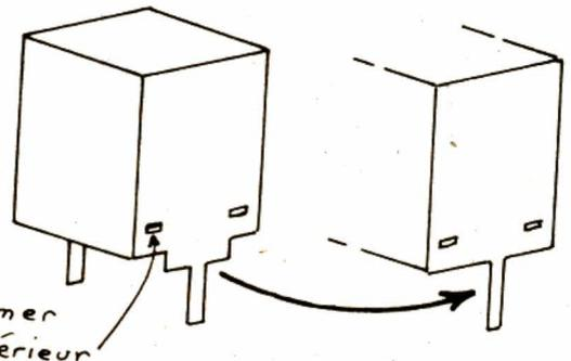
Fig. 16. — Modification du blindage de  $T_1$ .
