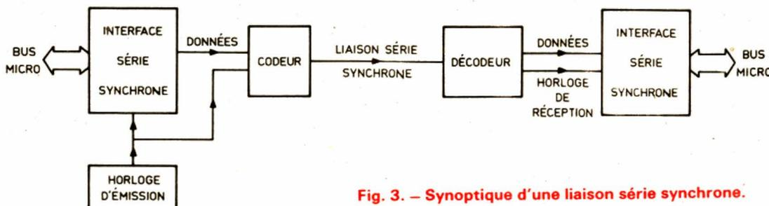
Fig. 3. - Synoptique d'une liaison série synchrone.
