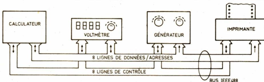
Fig. 6. - Principe de connexion sur un bus IEEE 488.
