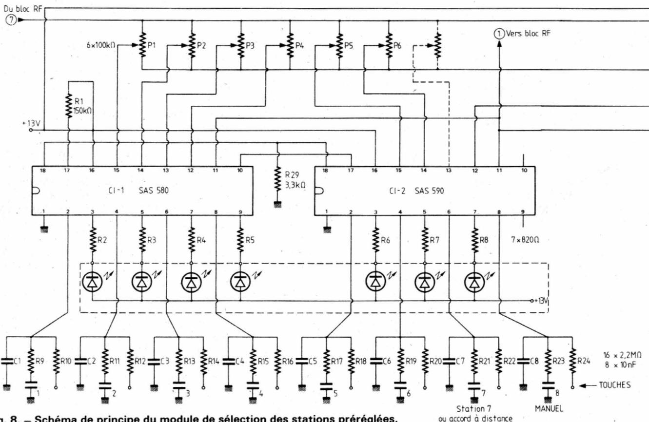
Fig. 8. — Schéma de principe du module de sélection des stations pré réglées.
