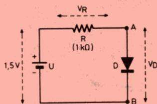
◀ Fig. 1. — Circuit régulateur à diode.
