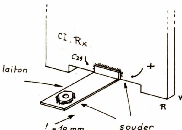
Fig. 13. - Mise à la masse du C.I. récepteur.
