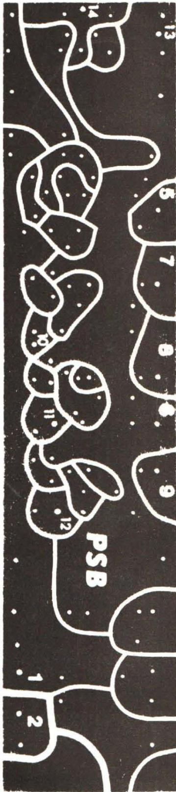
Fig. 10 : Représentation, à l'échelle 1/1, du circuit imprimé du montage comportant un microphone dans l'étage de liaison.
