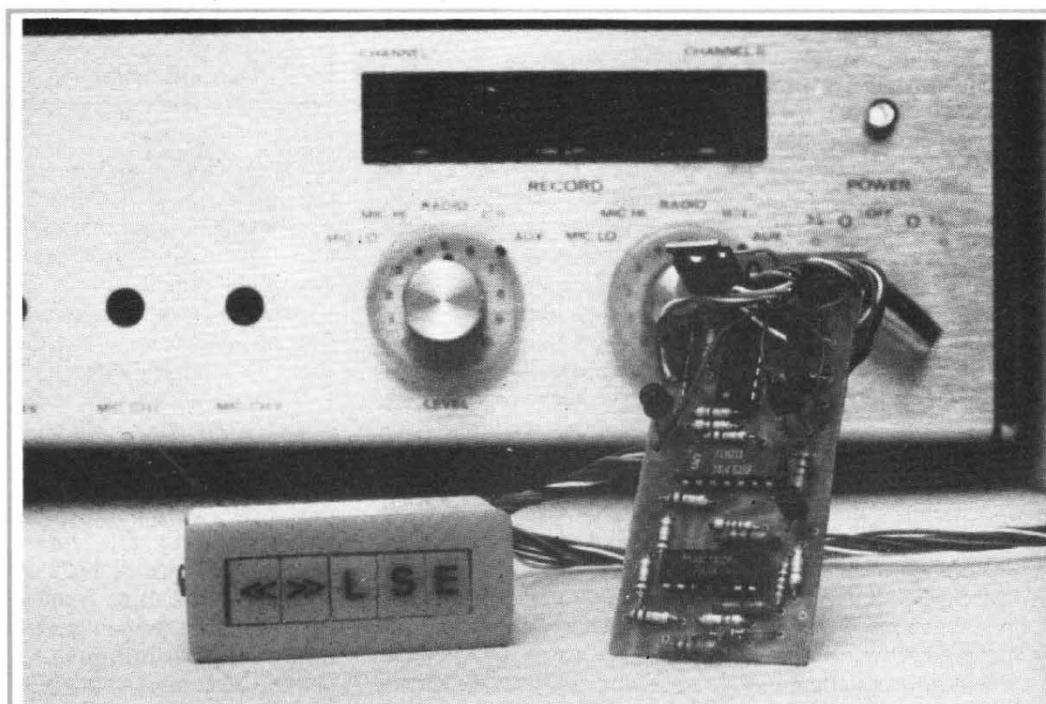
Photo B. - Boîtier de commande et section électronique, trois circuits intégrés, sept transistors, le transistor de l'alimentation n'a pas encore reçu son radiateur.
