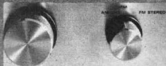
Deux boutons en tout et pour tout commandent le tuner : le plus gros entraîne l'index du cadran à trois échelles F.M., A.M. et repérage fin. Le second est monté sur l'axe du contacteur de gammes, soit F.M. et A.M. La position F.M. stéréo est choisie lorsque le voyant stéréo s'allume. Elle assure les commutations de cette fonction typiquement HI-FI.
