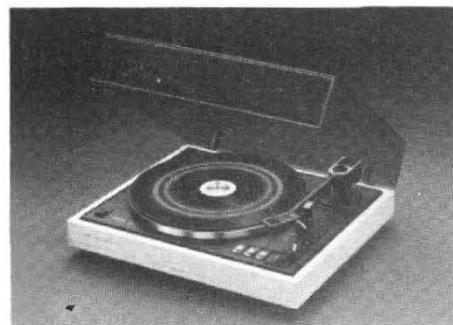
**La table de lecture GA222 :** Platine automatique à deux vitesses 33 1/3 et 45 trs/mn. Démarrage arrêt et sélection de la vitesse par touch contrôl avec indication par LEDs. Arrêt de fin de disque par dispositif électronique et retour du bras automatique. Entraînement du plateau par courroie. Ajustement des vitesses à  $\pm 3\%$ . Pleurage et scintillement  $< 0,2\%$  ; rumble  $< -41$  dB (DIN A) ; erreur de tracking  $< 0^{\circ} 9'/\text{cm}$ . Dimensions : 385 x 145 x 325 mm.
