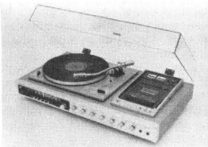
Le tourne-disque à moteur synchrone tétrapolaire deux vitesses 33 1/3 et 45 t/mn entraîne par courroie un plateau en aluminium massif injecté. Le bras est équipé d'une cellule magnétique, déclenche, en fin de disque l'arrêt automatique. Le magnétophone à cassettes est entraîné par un moteur à servo-générateur. Equipé du système DNL 5 pistes/2 canaux, livré avec deux microphones.
