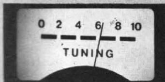
Un indicateur à aiguille mobile accorde au tuner RT 222 la touche d'élégance qui lui convient, et ses indications permettent de se régler finement et à coup sûr à la fréquence de l'émission désirée, que celle-ci soit puissante ou confidentielle. Le voyant rouge stéréo est situé près du vu-mètre.
