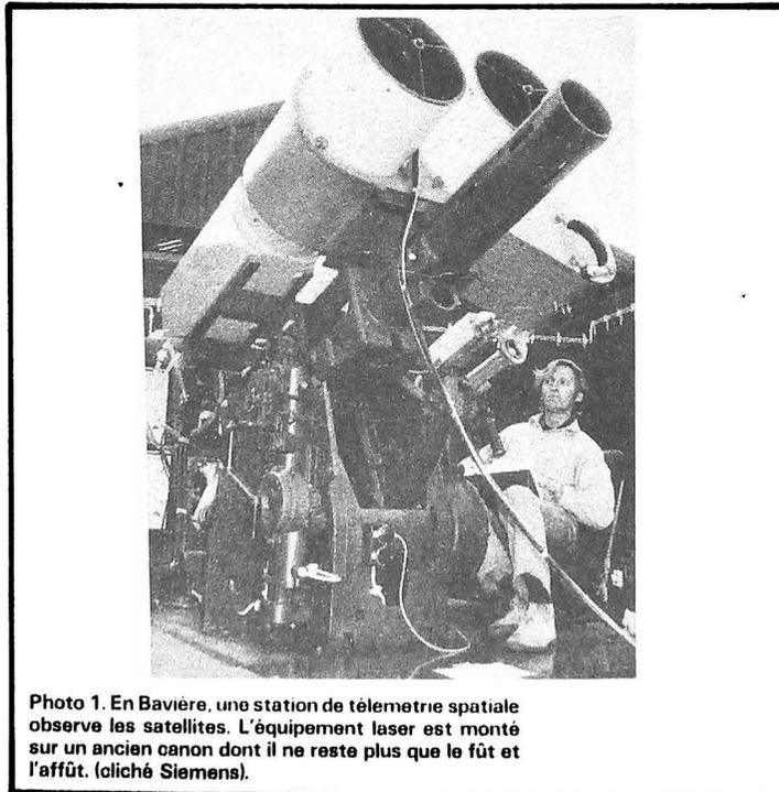
Photo 1. En Bavière, une station de télémétrie spatiale observe les satellites. L'équipement laser est monté sur un ancien canon dont il ne reste plus que le fût et l'affût. (cliché Siemens).
