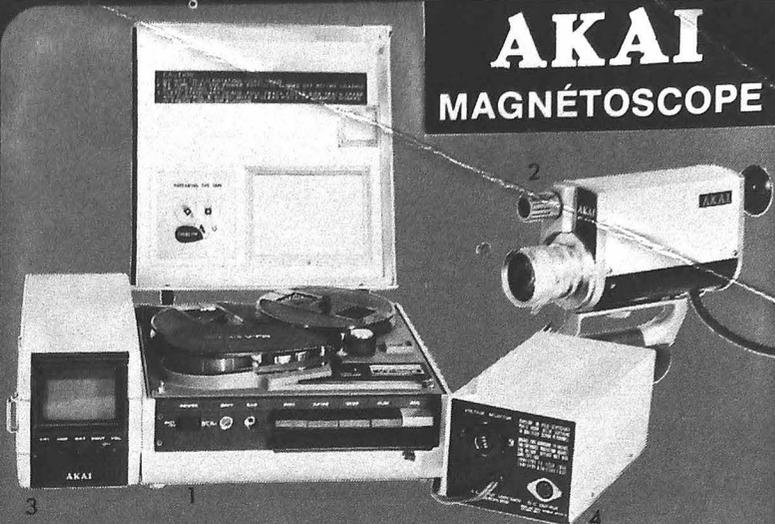
**Ensemble Akai VT 100 S.** 1) Magnétoscope portatif (compteur, arrêt sur l'image, réglage de compatibilité d'une prise micro supplémentaire). 2) Caméra (visée reflex, zoom 10-40 mm/ x 4). 3) Moniteur (écran 7,5 cm). 4) Bloc-alimentation.
