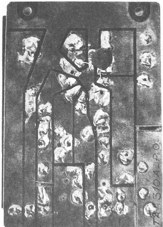
Photo 4 - Vue du circuit préamplificateur côté cuivre
