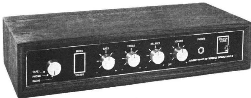
Ampli pré-ampli - 2 x 10 W - 5 entrées : tape, tuner, phono (magnétique, céramique et crystal) - courbe de réponse 35-20 000 Hz ± 3 dB - rapport signal - bruit - 52 dB - filtre anti-scratch (sifflements, bruits, parasites...) - prise de casque ...
