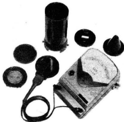
Cet appareil couvre une large gamme de mesures, de quelques lux à 30 000 lux, et même 200 000 lux avec accessoire.
