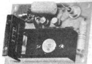
appliquée sur la base de  $T_3$  par le pont  $R_1$ ,  $P_1$ ,  $R_2$ . En cas de surintensité ou de court-circuit sur la ligne positive,  $T_3$  se bloque, provoquant ainsi par effet cumulatif le blocage de  $T_1$  et  $T_2$ .
