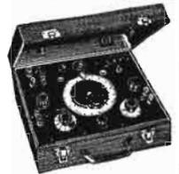
Permet la mesure des résistances, capacités, selfs.
