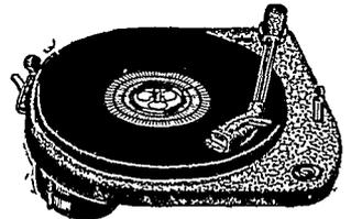
PLATINE 3 V. type 1954. Retour automatique du P.U. en fin de disque, par relai électromagnétique. Bouton de rejet. Réglage des vitesses. P.U. piézo à cellule réversible. Tension modulée 0,6 volts. Moteur 95 à 220 V. Long. : 340 ; larg. : 290. Net par 1 pièce ..... 10.650
