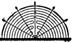
Fig. 16. — Propagation des ondes radioélectriques à la surface de la terre, d'après M. A. Blondel.
